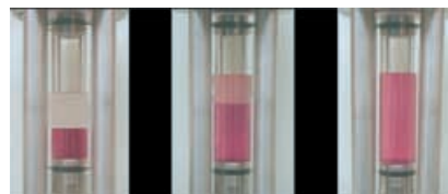
Abbildung 1. Die Anwendung von CO_2 -Druck für die Homogenisierung von organischen (Toluol, oben) und fluorigen ( FC-72 , unten) flüssigen Phasen. In der fluorigen Phase wurde ein farbiger Stoff gelöst. Man beachte das zunehmende Volumen. Fluorige Feststoffe können genauso in organischen Lösungsmitteln gelöst werden.
